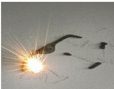
Laserstrahlschweißen im Pulverbett
