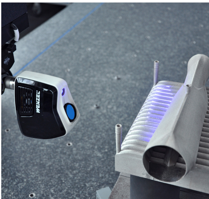
Abtastung eines AM-Bauteils mit einer Feinmessmaschine
