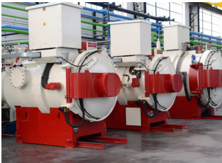
Wärmebehandlungsöfen zum Vakuumbärten
