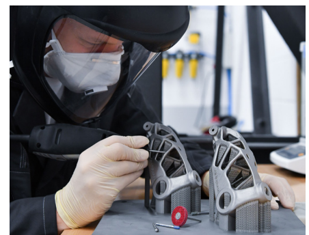
Entfernung der Stützstruktur eines Bauteils
