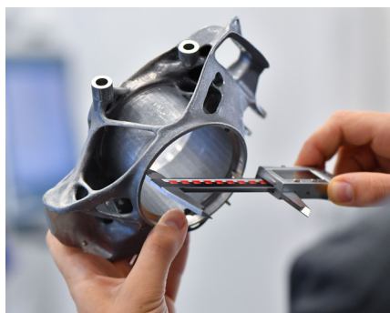
Qualitätsprüfung nach der mechanischen Bearbeitung
