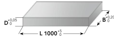
Präzisionsflachstahl mit Bearbeitungsaufmaß
