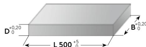
Präzisionsflachstahl mit Bearbeitungsaufmaß
