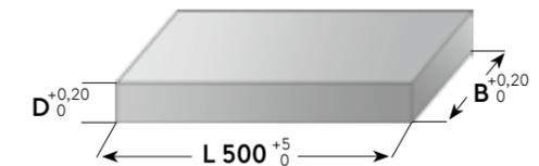
**Präzisionsflachstahl mit Bearbeitungsaufmaß**
