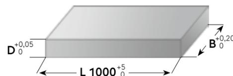
Präzisionsflachstahl mit Bearbeitungsaufmaß
