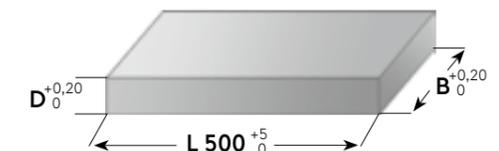
**Präzisionsflachstahl mit Bearbeitungsaufmaß**
