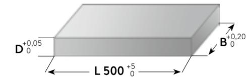
Präzisionsflachstahl mit Bearbeitungsaufmaß
